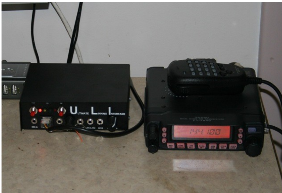
• Een voorbeeld van Packet Radio. Links de computerinterface die aan de HAM-radio (rechts) is gekoppeld.
