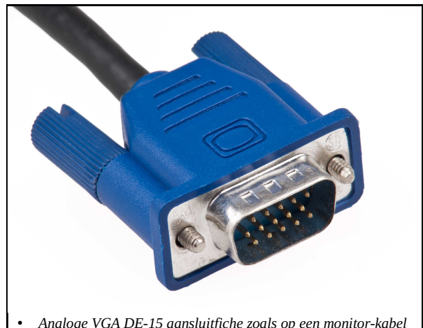
• Analoge VGA DE-15 aansluitfiche zoals op een monitor-kabel
